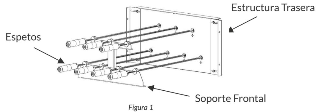
2. La Estructura Trasera debe ser el primer elemento a instalar. Para su instalación, el asador debe tener un muro trasero con 10cm de espesor, nivelado con el muro frontal de albañilería, que servirá de soporte, según la Figura 2.
